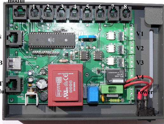
Regulátor z vnútra, vstupné aj výstupné, špeciálne konektory
