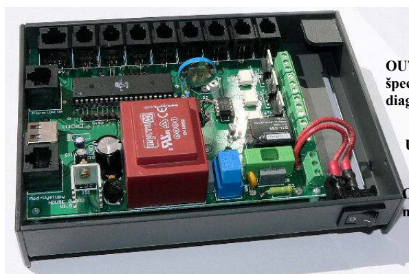
Regulátor z vnútra, vstupné aj výstupné, špeciálne konektory
